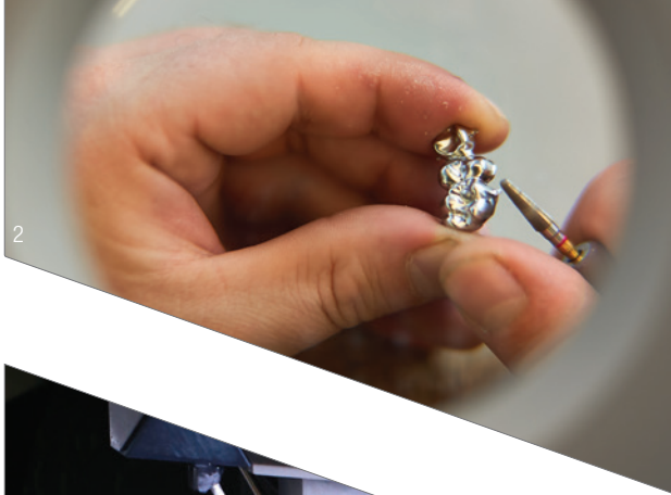
Abb. 1: Thomas Hack – Geschäftsführer INFINIDENT Solutions. Abb. 2: Post-Processing einer NEM-Brücke (NPM-milled). Abb. 3: Fertigung von NEM-Arbeiten im 5-Achs-Simultanverfahren.
